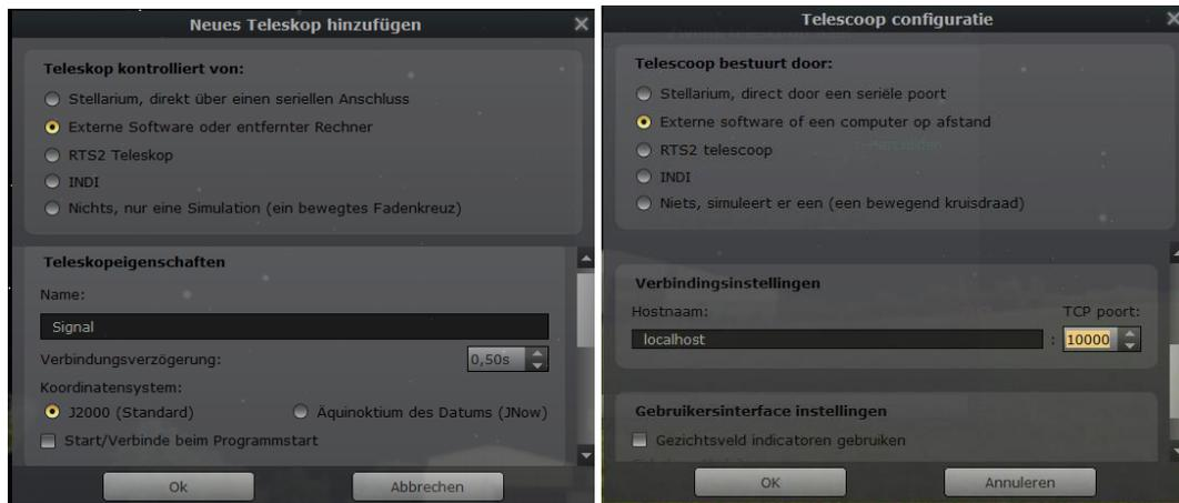
Das Teleskop kann nun mit stellarium verbinden, indem man auf Verbinden klickt. Wenn es nicht funktioniert, wird stellarium von neuem beginnen. Normalerweise wird das Teleskop dann erkannt. Das Teleskop meldet sich automatisch beim nächsten Start des Telescop-Steuerprogramms an.
